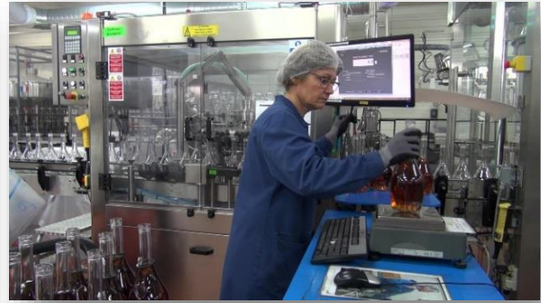
Les bouteilles sont contrôlées par pesée.
